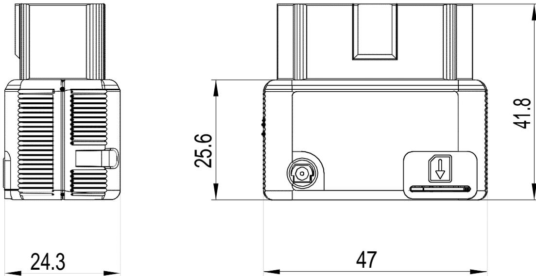
Рис. 1.5. Габаритный чертеж навигационного терминала iON Connect
