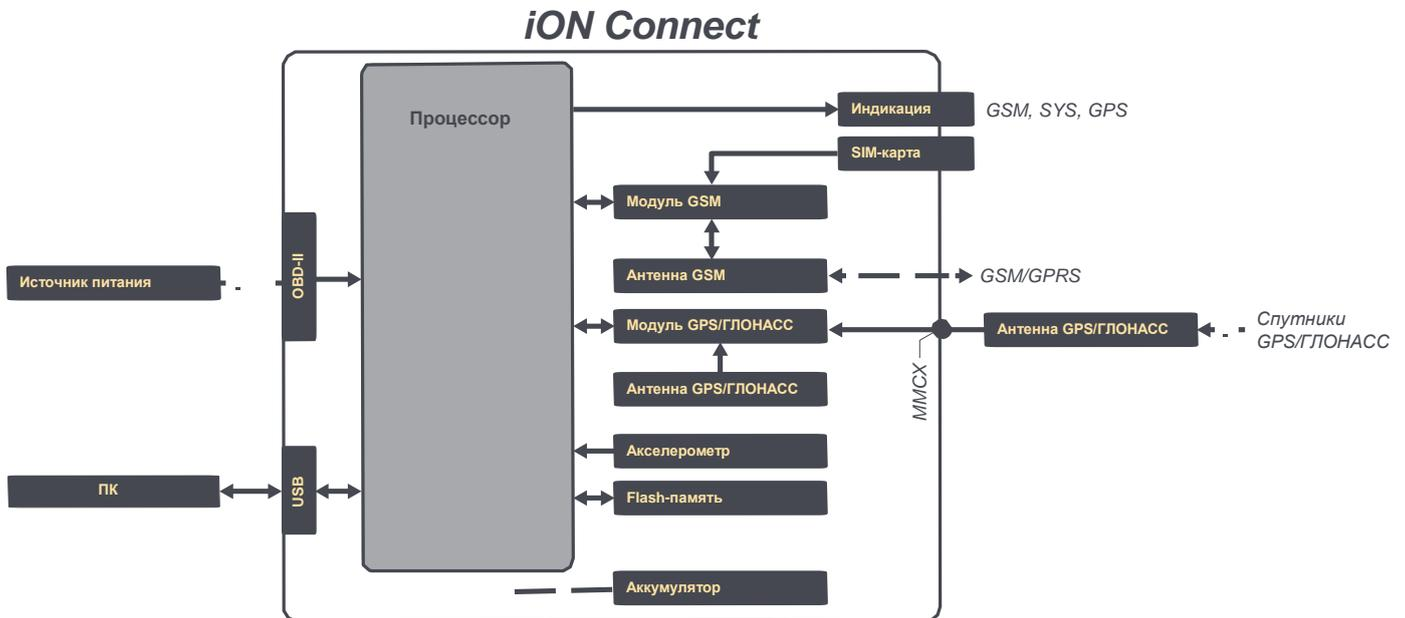
Рис. 1.3. Структурная схема навигационного терминала iON Connect
